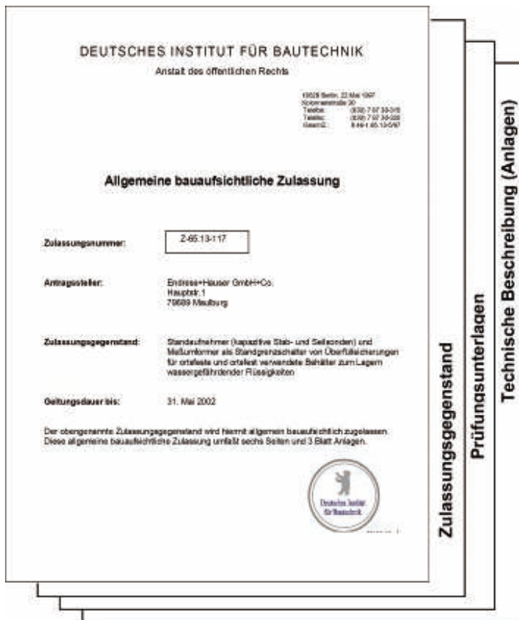
Bild 4 Allgemeine bauaufsichtliche Zulassung (Aufbau).
