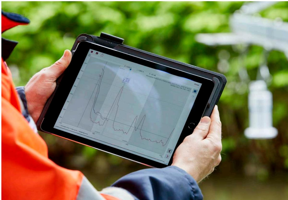
Radarmessgerät mit Bluetooth App (iOS, Android) für die Inbetriebnahme, Bedienung und Wartung – spart Zeit und reduziert Kosten
