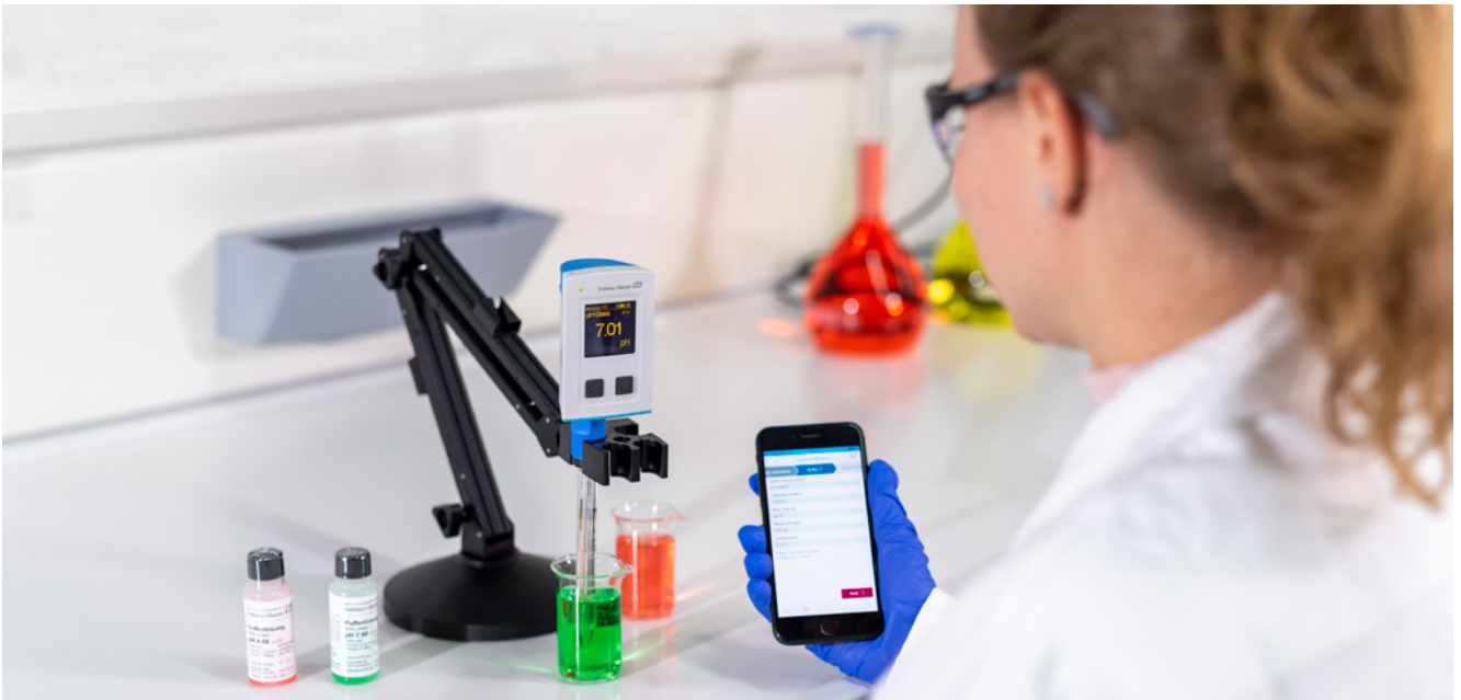
Kalibrierung eines pH-Sensors mit dem Handmessgerät Liquiline Mobile CML18 über die SmartBlue-App.
