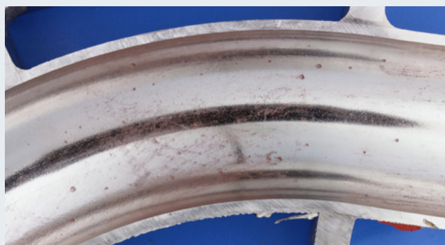
Coriolis-Durchflussmessgeräte erkennen mit Heartbeat Technology negative Einflüsse wie Belag oder Korrosion am Messrohr.
