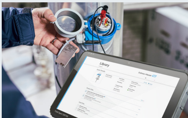
Das Multitool Field Xpert bringt vielfachen Mehrwert: bei Inbetriebnahmen, Konfiguration, Diagnose und Anlagenbegehung.
